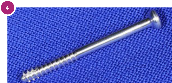
Abb. 4: Die resorbierbare 3,5 mm Magnesium-Zink-Calcium-Schraube (ZX00).
