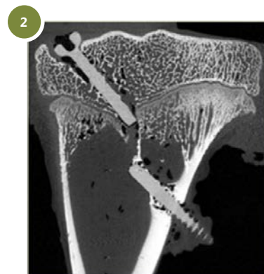
Abb. 2: \mu -CT Aufnahme transepiphysär, eingebrachter Mg-Zn-Ca Schraube mit gewolltem Bruch, ohne erkennbare Brückenbildung in der Fuge
